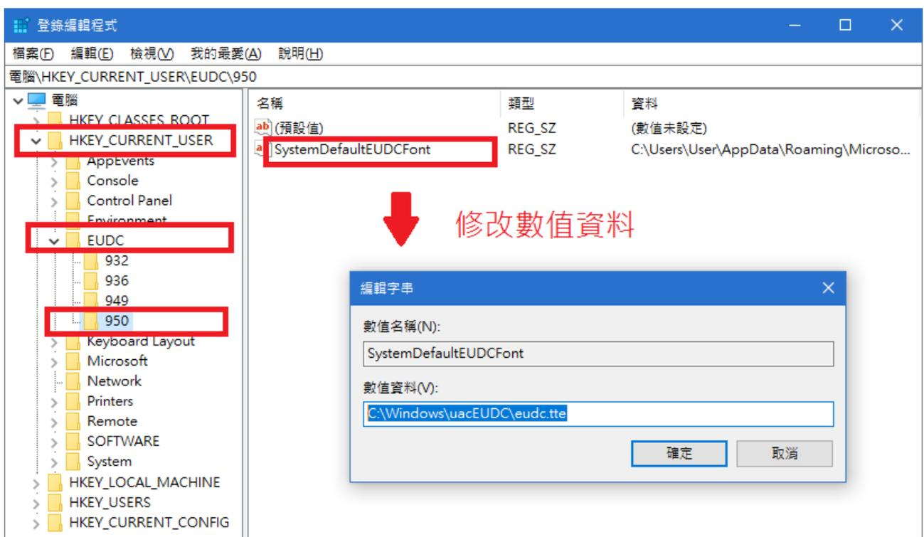
五、前述步驟在進入 HKEY\_CURRENT\_USER\EUDC 資料夾後若找不到 950 資料夾，則在 EUDC 資料夾下新增機碼，將名稱設置為「950」，並在 950 資料夾下新增字串值，將名稱設置為「SystemDefaultEUDCFont」，將數值資料修改為「C:\Windows\ucEUDC\eudc.tte」，點選「確定」之後重新啟動電腦。
